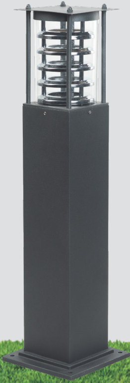
SS 222480 L: 15x15 cm H:70 cm Shape/Style : E27 Arm. Glass : Polycarbonate Material : Aluminium Paint : Electrostatice
